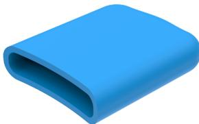
凸轮的保护性塑料盖。该保护盖安装在凸轮末端，能够防止刮擦涂层表面，防止嘎嘎作响，并使得凸轮运行更顺畅。
